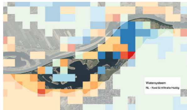
Afbeelding 12. Kaart met een indicatie van de kweldruk (blauw) en de mate van infiltratie (geel en rood). In het donkerblauwe deel is de kweldruk het hoogst.
